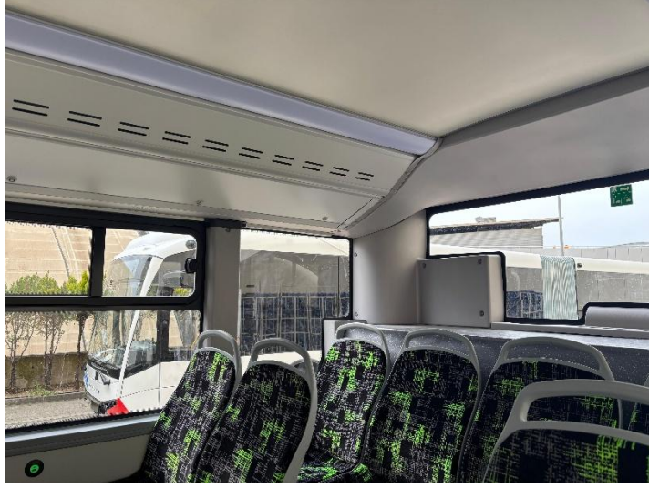
Şekil 11 Atak Aracı Arka Bölüm Hava Kanalı
