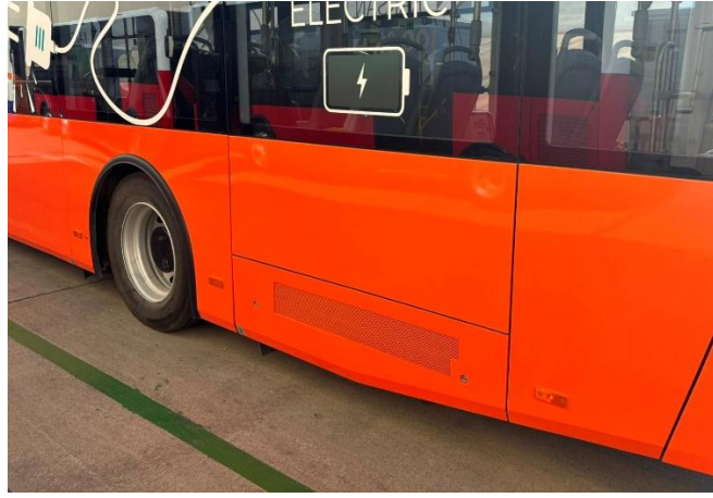
Şekil 4 Radyatörün Araç Üzerinde Konumlandırılması
