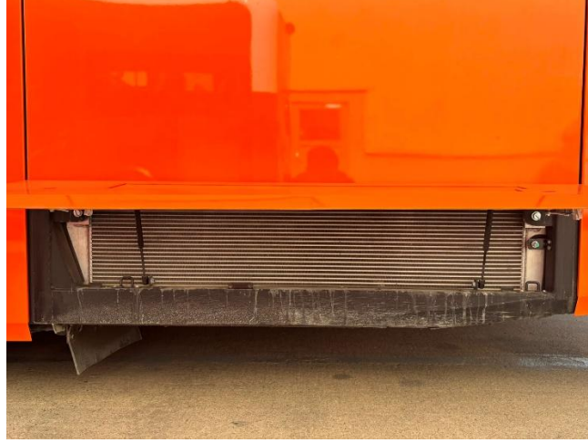
Şekil 5 Soğutma Çevriminde Kullanılan Radyatör
